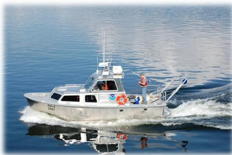
Una pequeña lancha hidrográfica típica utilizada para los levantamientos costeros y portuarios.
