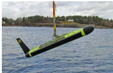
Side Scan Sonar (L-3 Klein 5000 V2)
