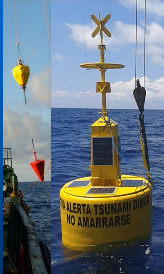
Sistema de detección y monitoreo de Tsunami
