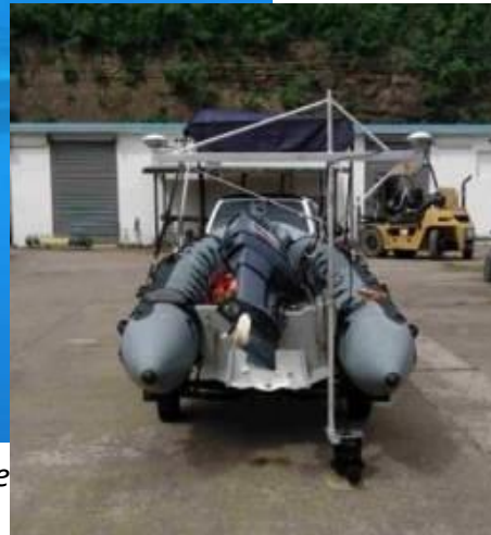
MBES Norbit iWBMSH intégré au système déployable d'hydrographie militaire du Shom (SDHM)
