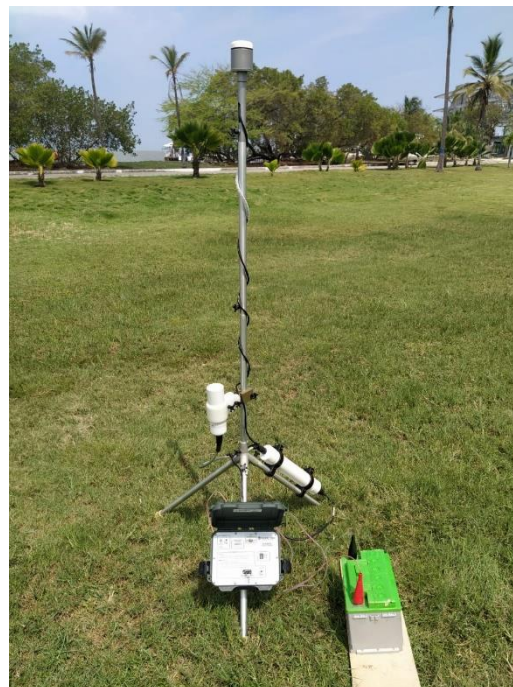
Figura 12: Estación de magnetómetro terrestre para corrección de remota
