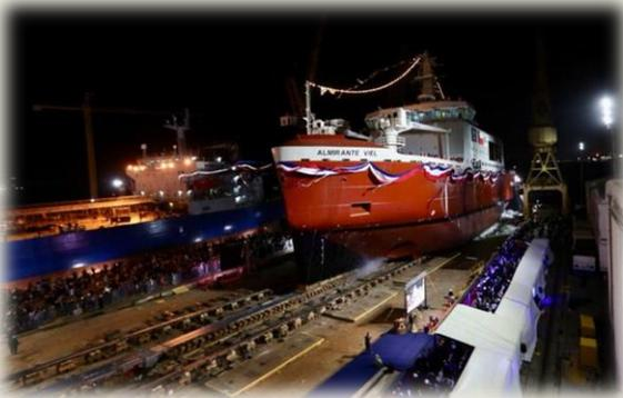
Primer y más grande Rompehielo hecho en Chile construido por ASMAR Talcahuano. Equipado con un ecosonda multihaz de alta y media profundidad, sonar de rebusca omnidireccional, winches oceanográficos y laboratorios de microbiología, macrobiología y químico.
