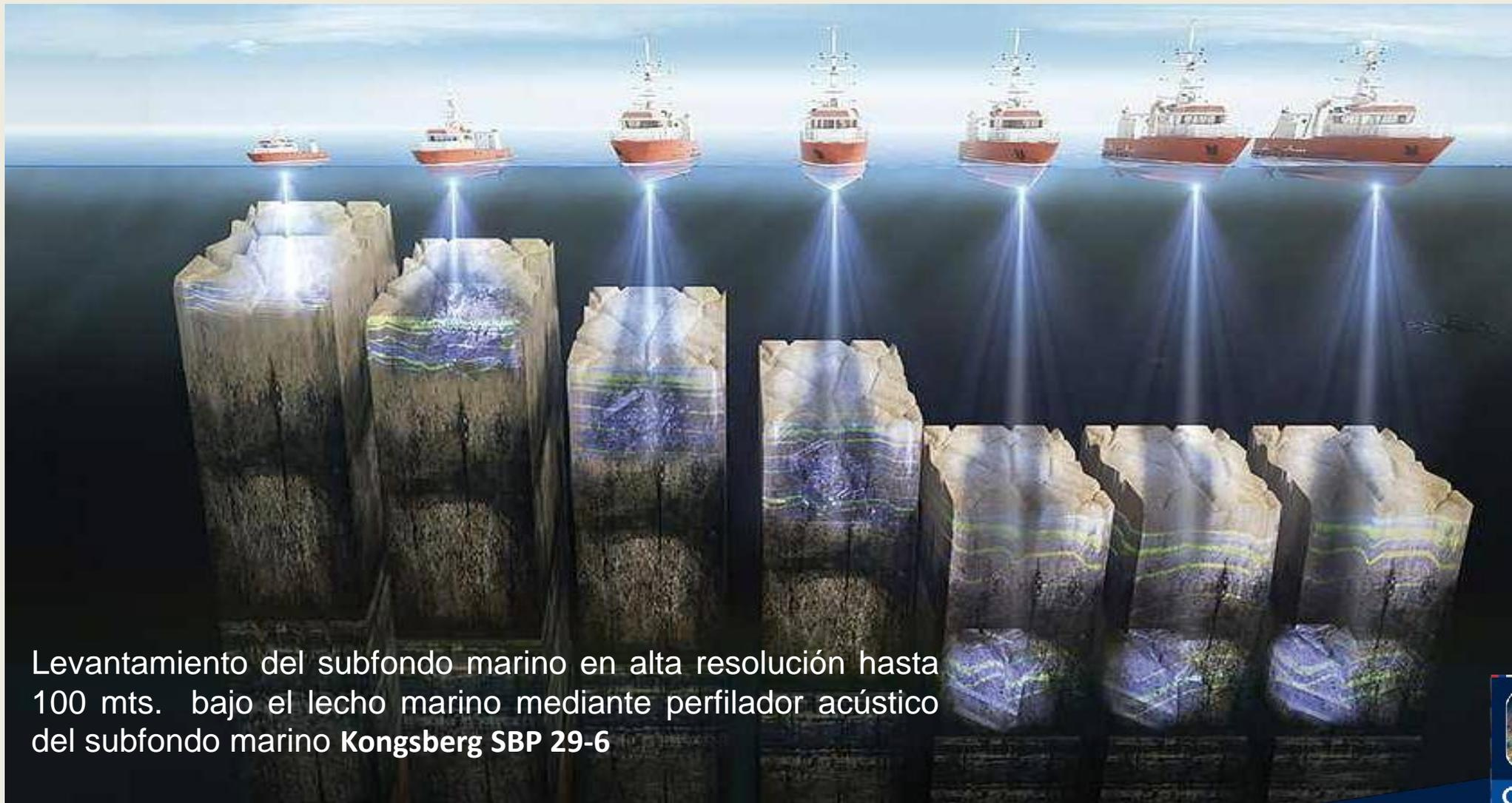
Levantamiento del subfondo marino en alta resolución hasta 100 mts. bajo el lecho marino mediante perfilador acústico del subfondo marino Kongsberg SBP 29-6
