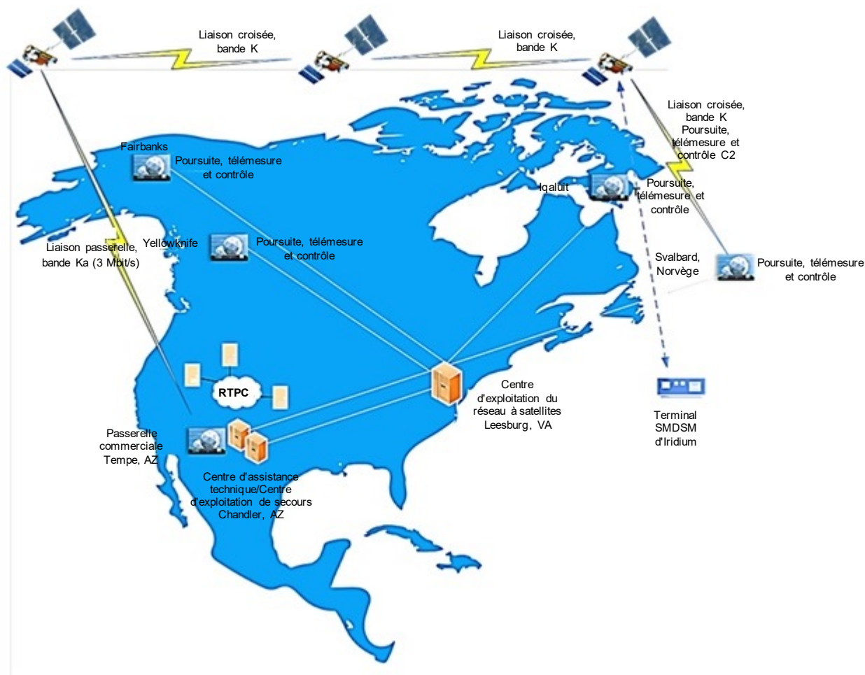
Figure 7 - Le système mondial à satellites d'Iridium, vue d'ensemble du réseau (Amérique du Nord et centrale)
