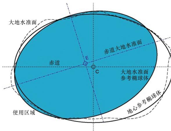
图 2.4 地心和非地心局部参考椭球体（经线剖面显示“最佳拟合”的使用区域）
