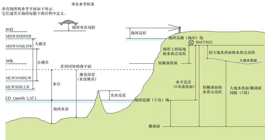
图2.10 陆地地图和海图的垂直基准
