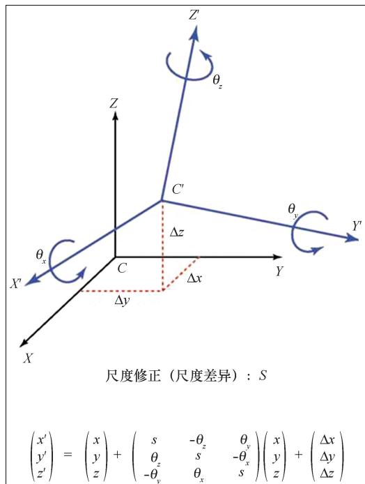
图2.9 两个大地测量基准的相似转换模型
