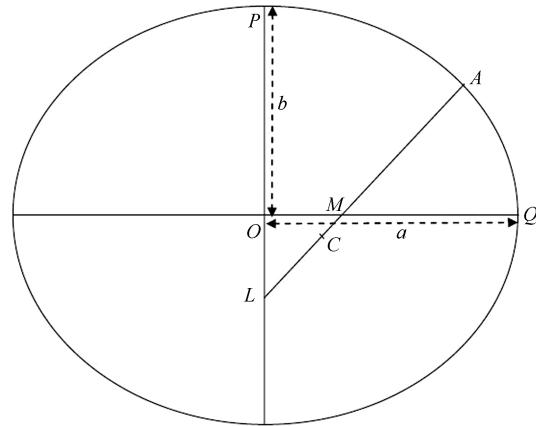
图3.10 椭球横截面（用于对极轴扁率进行图示）
