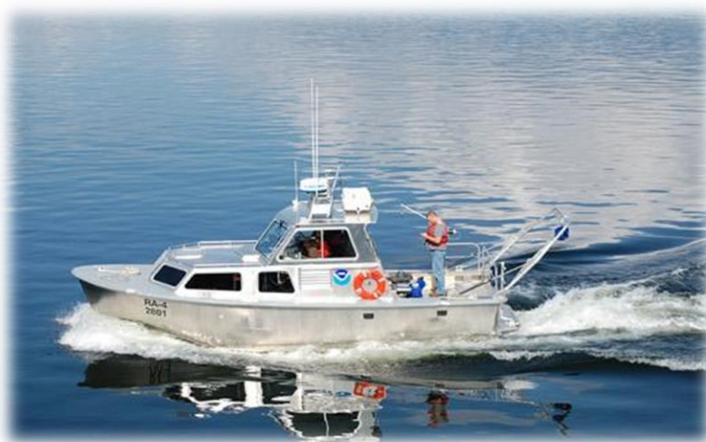
Petite vedette hydrographique typiquement utilisée pour les levés côtiers et portuaires
