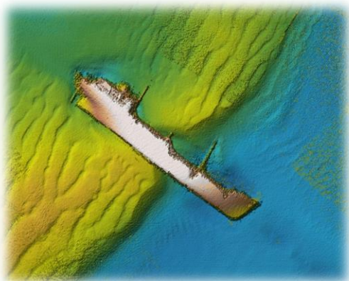
Epave détectée à l'aide du sonar à balayage latéral
